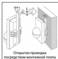
**Указание:** Для монтажа к стене можно использовать имеющийся в комплекте монтажный угольник. Благодаря этому проводка можно проложить, проведя их за стенкой сенсора в отверстия, предусмотренные для открытой проводки.
